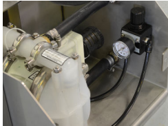
Regulador de presión con bomba de doble membrana
