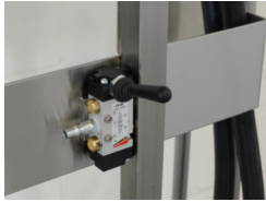
Conexión neumática con palanca de activación/desactivación
