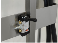
Druckluftanschluss und Ein-/Ausschalthebel
