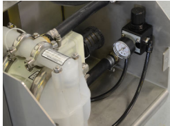
Druckregler und Doppelmembranpumpe
