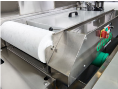
Kreislauf tank mit Schrägfilter
