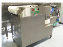
Réservoir à circuit fermé avec filtre incliné
