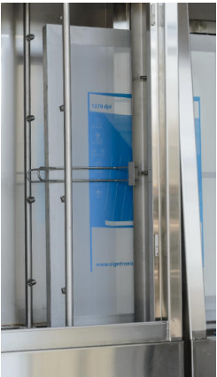
Benetzungsmodul zum Aufweichen der Emulsion
