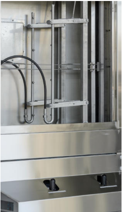
Oszillierende Düsen auf beiden Seiten des Siebes
