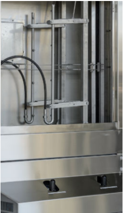
Buses oscillantes sur les deux côtés de l'écran
