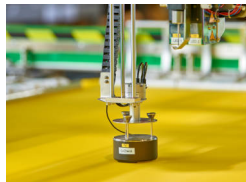
Tensado de la malla controlado por programa
