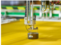
Programmgesteuertes Spannen des Gewebes
