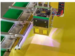
Endurecimiento del adhesivo mediante UV-LED
