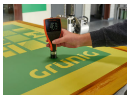
Mesure de l'épaisseur de la couche et de la rugosité de la surface
